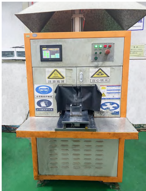
自動氬焊機 Automatic welding machine
