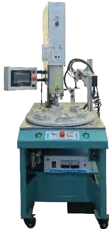
自動超聲波壓接機 Automatic ultrasonic crimping machine
