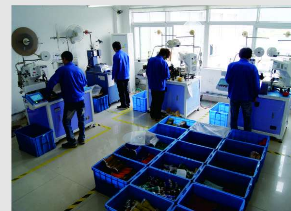
自动压接 Automatic crimping
