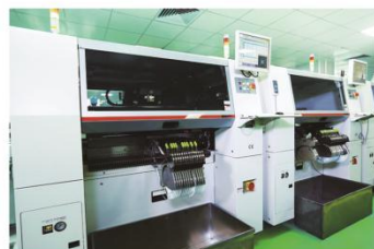
▲ 三星贴片机 SAMSUNG SMT machine
