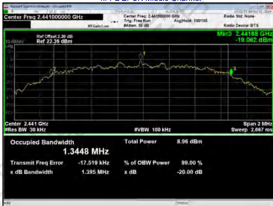
\pi/4 -DQPSK Middle Channel
