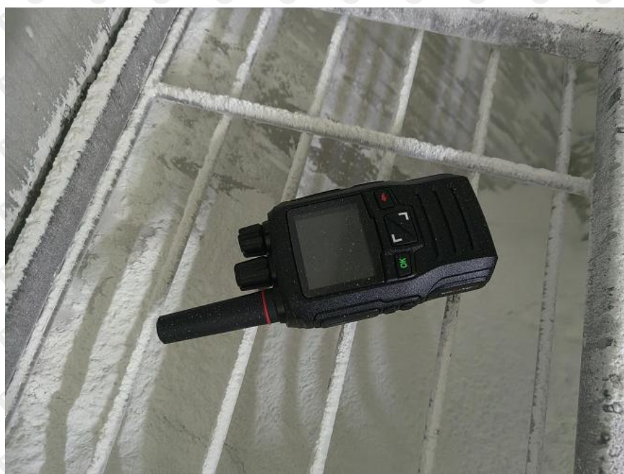
照片2: IP6X防尘试验测试中
