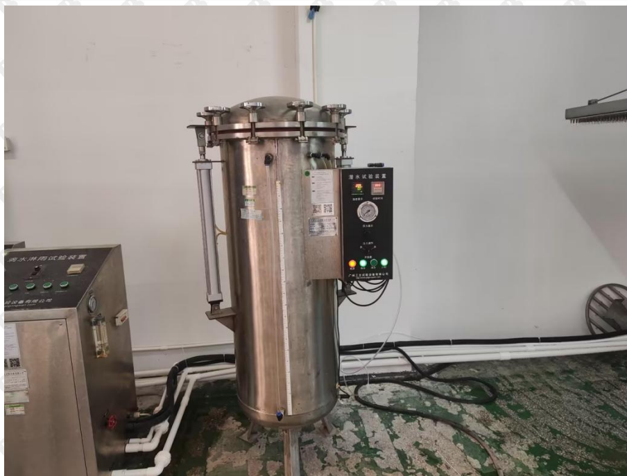
照片 3: IPX8防水试验测试中
